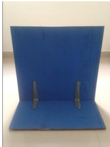
Figura 4: Suporte do densímetro, já pregado e parafusado para melhor fixação.
