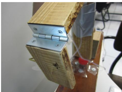
Figura 1 – Unindo as partes do braço com a dobradiça
