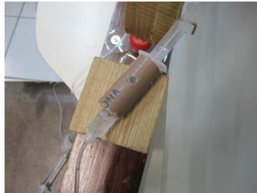
Figura 6 – Cano de PVC preso ao cubo, e seringa ligada ao pedaço 3
