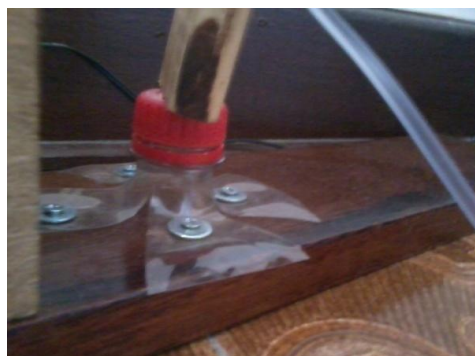
Figura 2 – Fixação da base giratória na base
