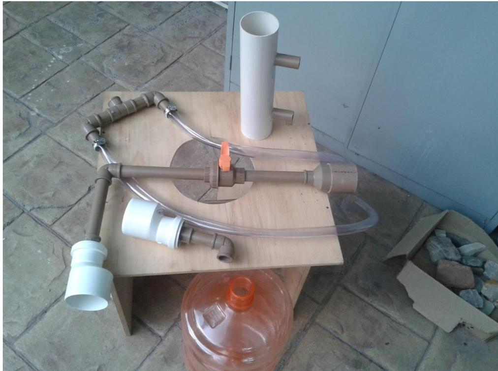
*Figura 4: Estruturas para montar o Tubo de Pitot.*
