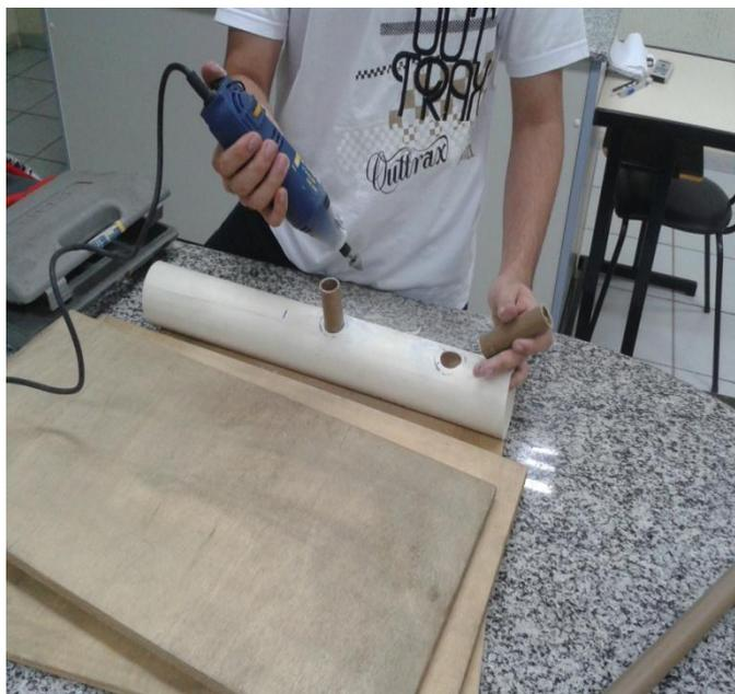
**Figura 1:** Tubo de 75mm com dois canos de PVC  $\frac{3}{4}$ .
