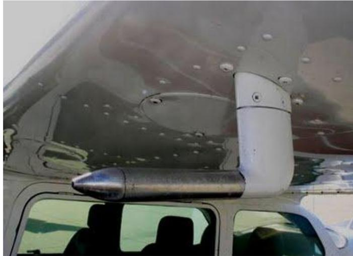
Figura 1 – Tubo de Pitot instalado sob a asa de um avião.
