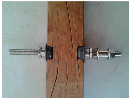
Figura 13: eixo de bicicleta e o rolamento colocados na parte móvel do psicrômetro
