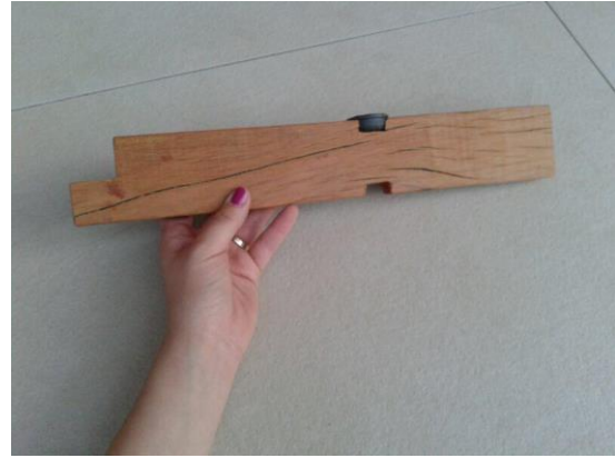
Figura 12: rolamento do eixo de bicicleta encaixado no local entalhado.
