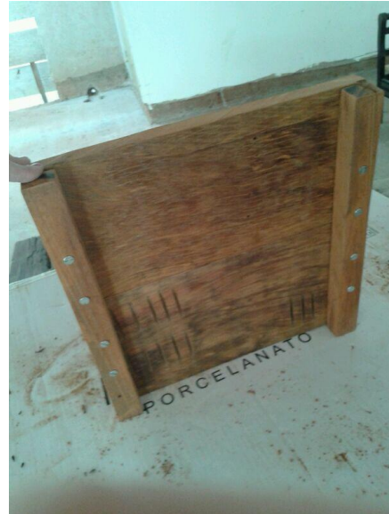
Figura 8: Base de madeira fixada com oito parafusos.
