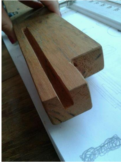
Figura 14: (a) profundidade do entalhamento; (b) entalhamento finalizado \ local para colocar os dois termômetros.
