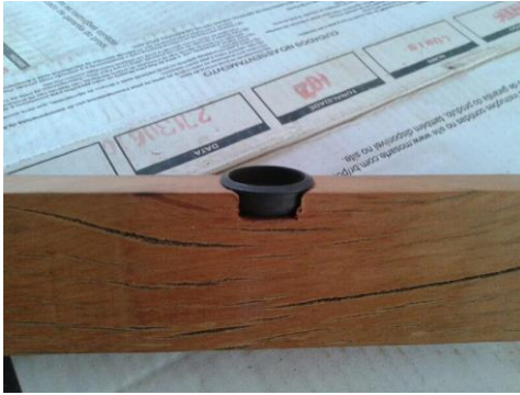
Figura 12: rolamento do eixo de bicicleta encaixado no local entalhado.
