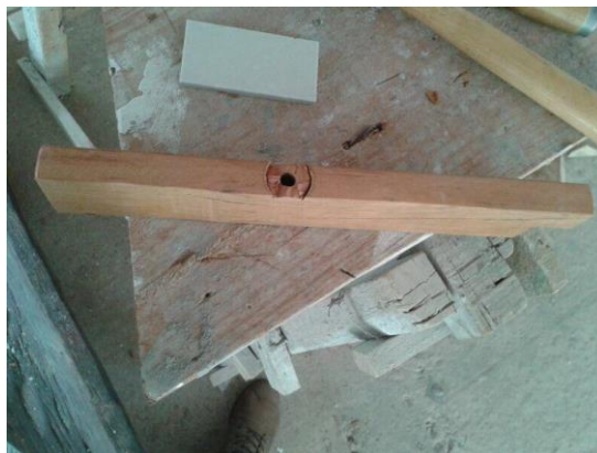
Figura 11 : começando a entalhar em volta do furo
