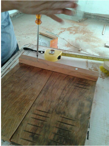
Figura 7: colocando parafuso com uma chave de fenda para unir os pedaços de madeira.
