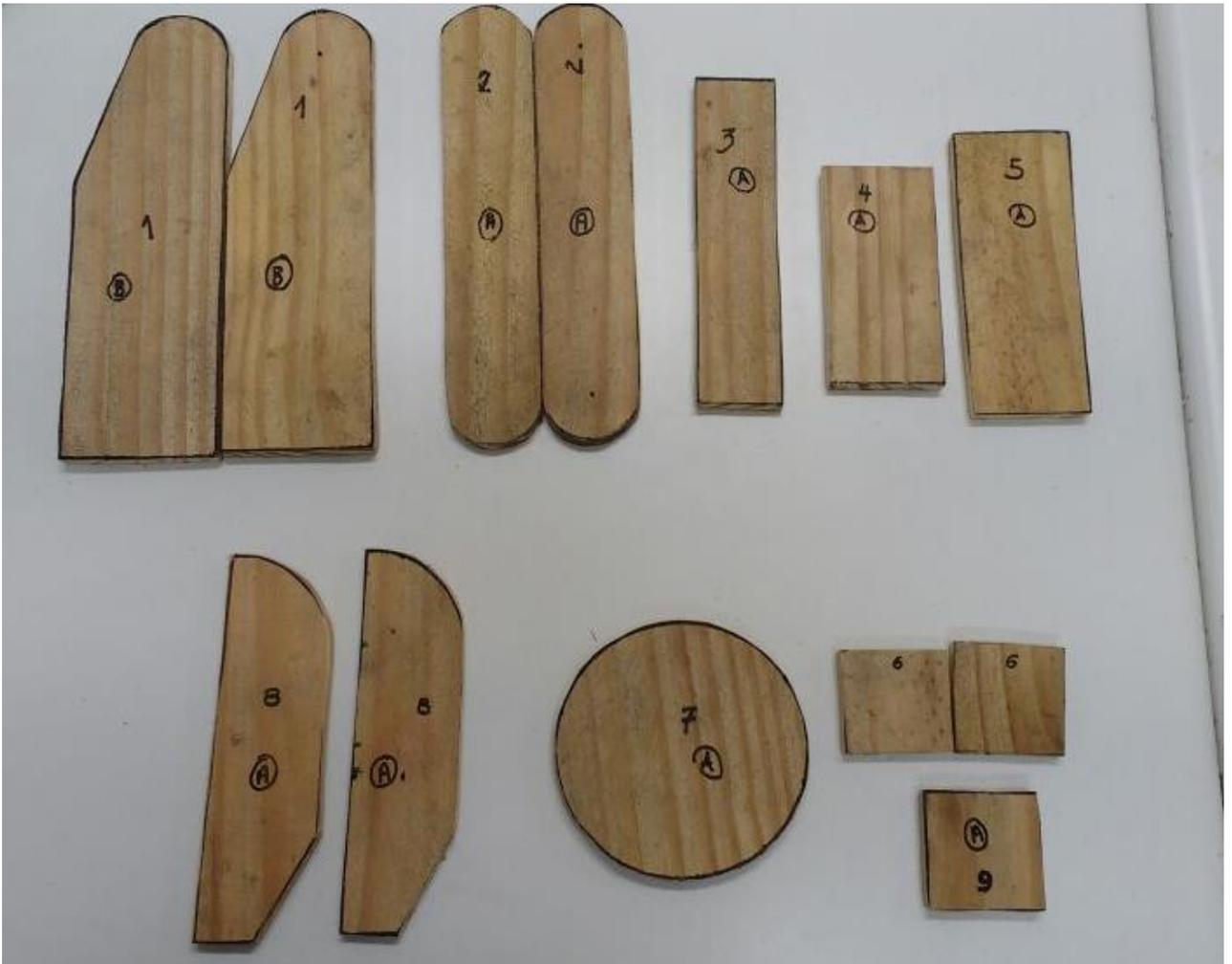
Figura 6b: Madeiras cortadas nos tamanhos necessários para formação da garra.
