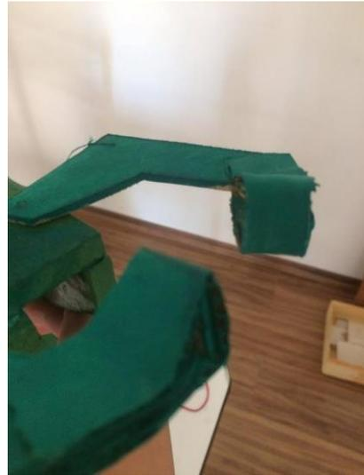
Figura 19: Colagem do papelão na ponta da garra para elevar os objetos.
